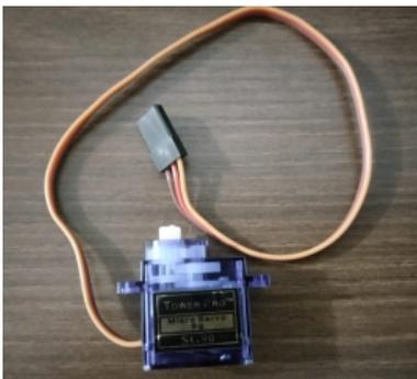
Figura 4.8: Motor servo 9g SG90 TowerPro
