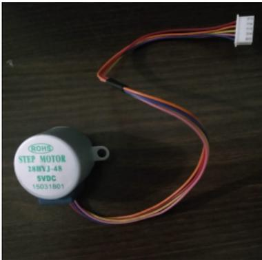
Figura 4.6: Motor de passo 28BYJ-48
