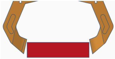
Figura 4.2: Modelo 3D da garra segurando a peça de Jenga
